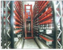
Le chariot manipulateur du magasin soulève les cassettes de stockage avant de les transférer, évitant ainsi les phénomènes d'usure liés au contact.
