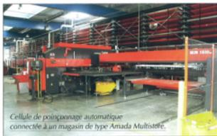
Cellule de poinçonnage automatique connectée à un magasin de type Amada Multistore.
